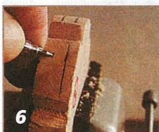
Зажав заготовку в тисках, её размечают на три слоя толщиной по 5 мм.
