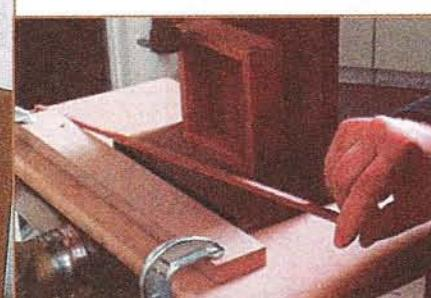
**На выключенном сверлильном станке зажимают в патрон специальную оправку и фрезу и подводят к ним корпус на приспособлении так, чтобы фреза подошла к отметкам (см. фото-вставку). Устанавливают глубину запила, вставив между кареткой приспособления и ограничителем простоявку или отложив между ними нужный размер (10 мм для маленькой петли). Удалив прокладку, включают станок и по отметкам петель надвигают корпус на фрезу.**
