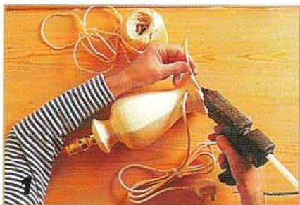
Конец обмоточного шнура надо закрепить на основании лампы. Это можно сделать с помощью kleевого термопистолета.
