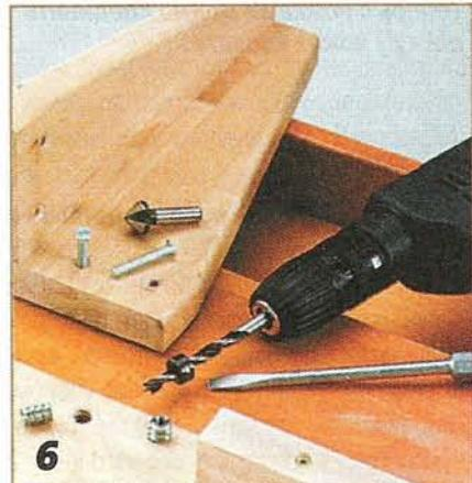
**Угловые ножки крепят на болтах с потайной головкой и врезных гайках, предварительно просверлив под них и раззенковав отверстия требуемой глубины.**
