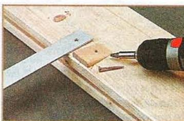
Этот клин 10x30x50 мм определяет положение металлической полосы, которая поддерживает полочки сзади. Крепят его и полосу шурупом с тыльной стороны собранной рамы.
