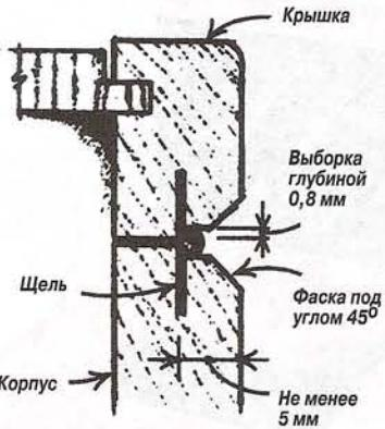
**Рис. 1. Простая вертикальная щель.** Для маленькой петли вертикальная щель должна размещаться на расстоянии 5 мм от ребра (на расстоянии 6 мм от ребра – для большой петли). Фаски под углом 45° должны заканчиваться на расстоянии не более 1,0 мм от внешнего края щели. Для цилиндра петли в крышке и корпусе делают выборку глубиной 0,8 мм.
