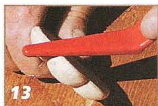
Чтобы придать розетке объёмность, нижнее ребро зачищают рашпилем или напильником.
