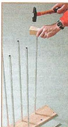
Алюминиевые трубы Ø 16 мм аккуратно забивают в глухие отверстия, нанося лёгкие удары молотком через деревянный брускок.
