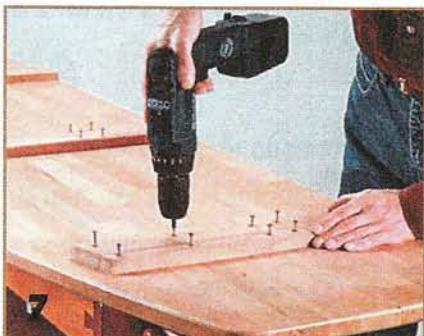
**Детали 1 и 2 изголовья соединяют на шкантах, дополнительно скрепляя их с тыльной стороны вот такими накладками.**
