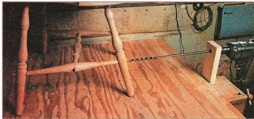
Для сверления отверстий к проножкам автор использует брусок 50x100 мм со сквозным отверстием, которое служит направляющим для дреши. Чтобы избежать расщепления, сверло с удлинителем (приваренным к сверлу штырем) извлекают, когда центрирующий кончик выходит наружу. Затем отверстие сверлят с другой стороны.
