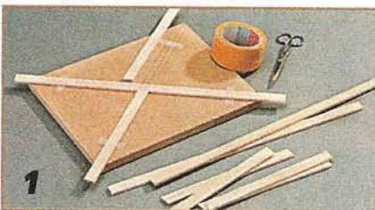
При сборке боковых крестовин планки крепят к «стапелю» двусторонней клейкой лентой. Одну из планок в средней части разрезают под углом 15° с помощью стула.
