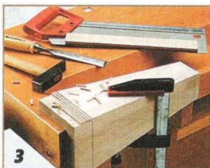
**В верхней части собранных угловых ножек делают вырез глубиной 5 мм. Прикрепив двухсторонней клейкой лентой глубинный упор, на ножке с помощью мелкозубой пилы совершают ряд взаимно параллельных пропилов с последующим удалением стамеской древесины между ними.**
