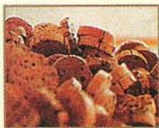
**Заготовки для пробкового покрытия, нарезанные из бутылочных пробок.**
