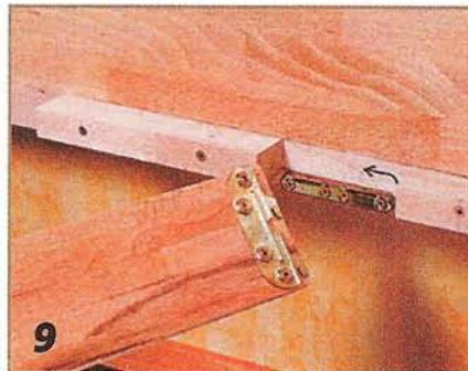
**Сбоку вставляют и крепят центральную опору, предварительно прикрепив к ней подпорку ввёртываемыми сверху шурупами.**
