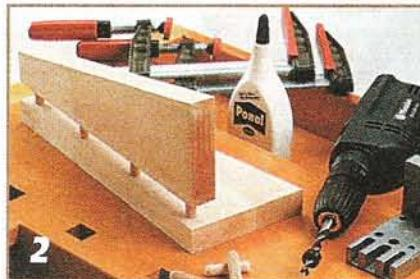
**В одной из деталей ножек отверстия под шканты сверлят на пласти, в другой, ответной – на кромке. Пользуются при этом специальным сверлильным кондуктором и сверлом с ограничителем глубины сверления.**
