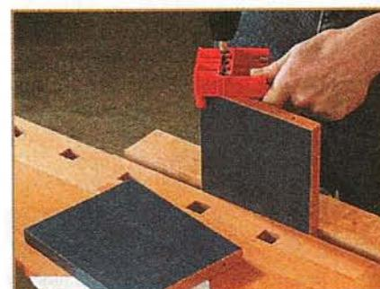
**Полочки крепятся к боковым панелям самодельными алюминиевыми полкодержателями, нарезанными из прутка Ø7,5 мм. При этом зазор между боковыми панелями и полочками должен быть равен 16 мм.**
