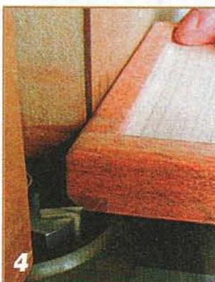
Сняв фаску, на корпусе и крышке для цилиндра Ø1,5 мм петли делают выборку немного глубже 0,8 мм.
