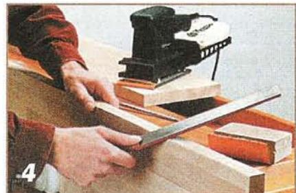
**Поверхности деталей обрабатывают шлифовальной шкуркой №120. Все открытые взгляду кромки притупляют шлифовальным утюжком или напильником.**
